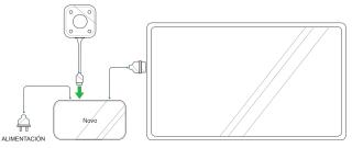
1 Conecte el LauncherPlus al dispositivo NovoConnect.
